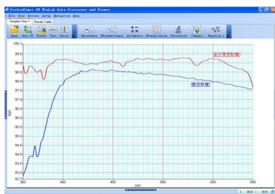
与以往采用镀银蓝区反射镜的反射效率比较
