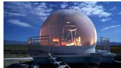
天光所承担。该系统集成了薄镜面主动光学、幸运成像、碘盒定标高分辨视向速度测量( $R=60000-120000$ ,  $RV=1m/s$ )等一系列新技术手段。此套设备将服务于恒星物理研究中两个主要的科学目标:(1)基于幸运成像技术的微引力透镜方法探测系外行星;(2)基于视向速度的星震学方法研究恒星内部结构。这是当前时域天文学的两个典型科学目标,其科学成果依赖于网络的建设。中国 SONG 项目是国际网络的一个节点,也是成功实现科学运行的第二个节点。中国节点的成功,意味着国际 SONG 计划继去年10月丹麦的 SONG-Hertzsprung 望远镜进入单节点运行之后,可以进入正式的网络化运行。这是实现整个网络科学目标极其重要的一个环节。在实现初光后,在站
