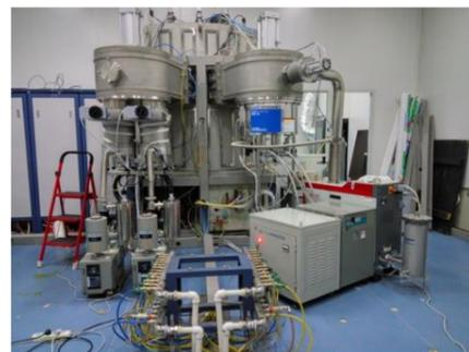
了使LAMOST望远镜子镜在使用过程中达到反射率要求,需要采取清洁维护及镜面镀膜等方式来保持和提高镜面反射率,其中镀膜则是从根本上提高镜面反射率的途径。而大口径光学元件的镀膜工作,尤其是金
