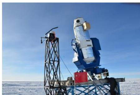
南极巡天望远镜 AST3 是在中国南极天文中心的组织下建设的我国第二代南极天文光学设备,包括三台入瞳直径 500mm,配置 g, r, i 三种不同滤光片的大视场巡天望远镜,是南极首套可远程遥控无人值守运行,也是口径最大的南极光学望远镜。
