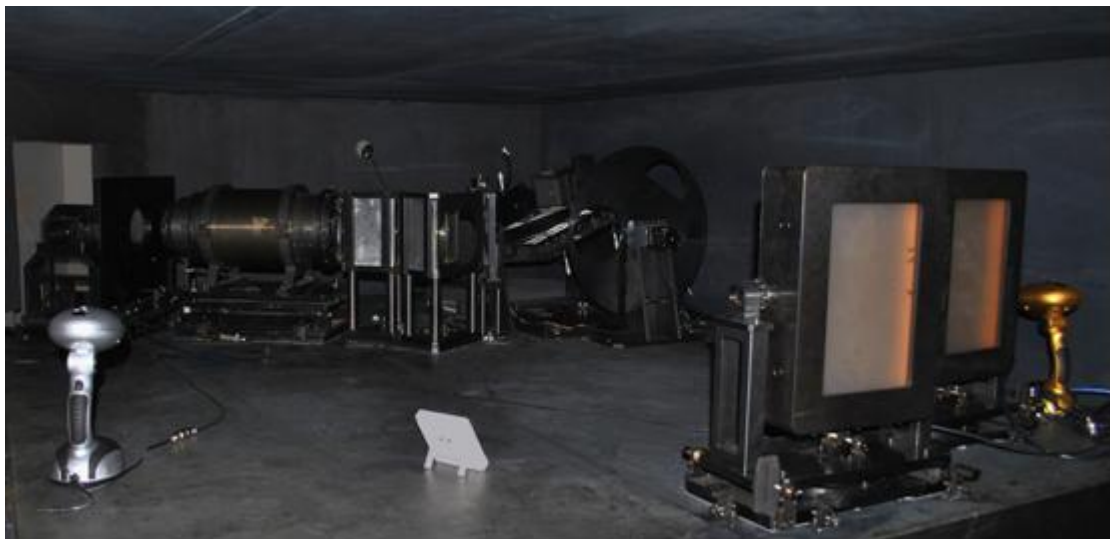
图1. 密封罩内气浮平台上的高分辨率光谱仪
